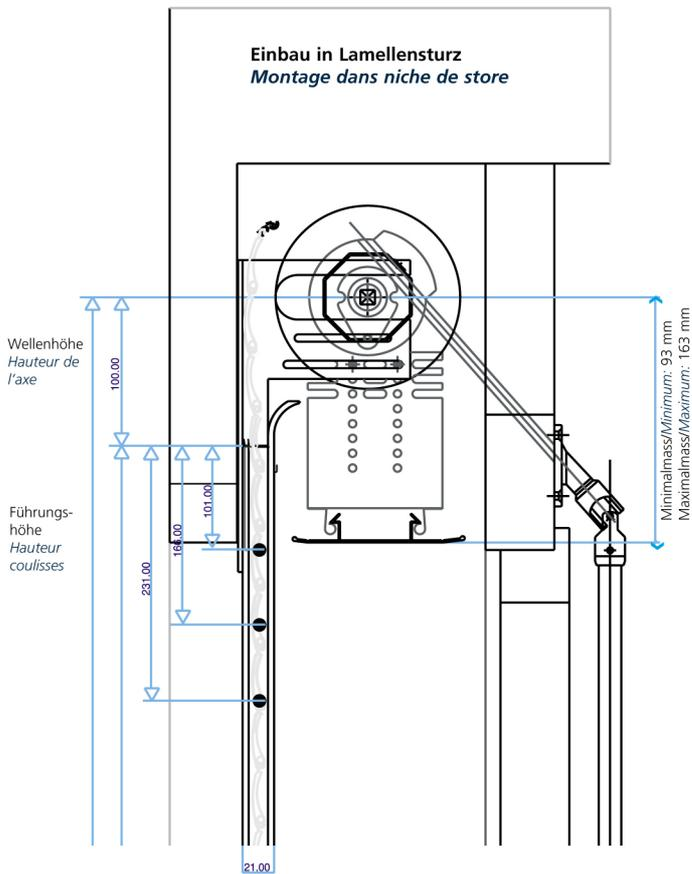
ECOMONT ist ein universelles, modernes Rollladensystem und lässt sich sowohl bei Renovationen in bestehende Kästen wie auch in Lamellen-Stürze ab 130 mm Tiefe einbauen. Die Untersichtblende wird mit einem Klipp-System direkt an der Konsole befestigt. Die automatische Hochschiebesicherung ist direkt auf die Welle montiert. Hand- sowie vollautomatische Bedienung möglich. Bei Neubauten empfiehlt sich eine Sturzabmessung von 150 – 170 mm.
